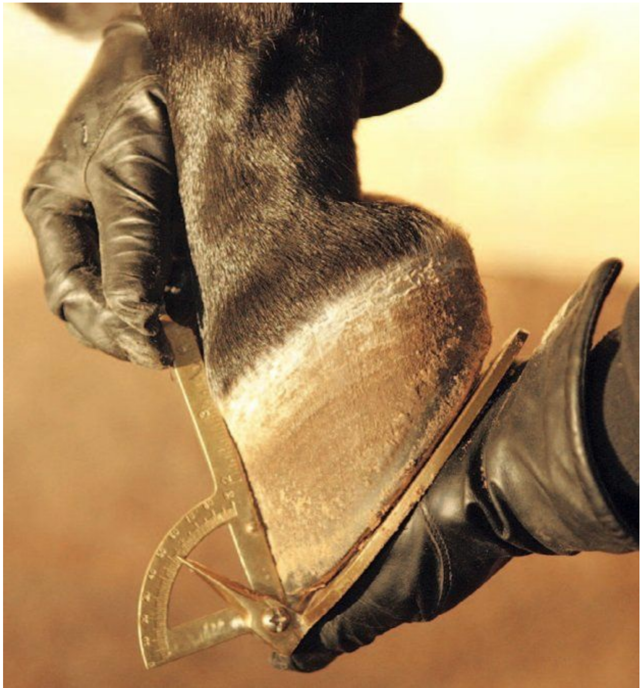
Fig. 1.3. Hoof gauge. © Nevzorov Haute École
