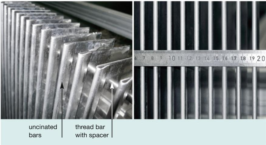
**Fig. 4.18** Screen with uncinated bars (Ingenieurbüro Floecksmühle GmbH)
